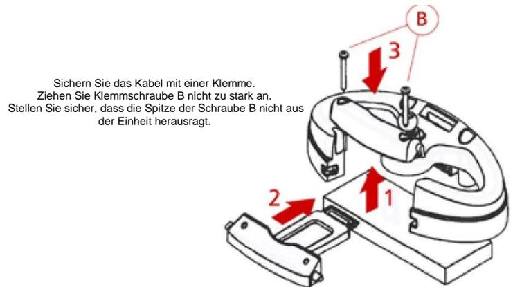
Sichern Sie das Kabel mit einer Klemme.
