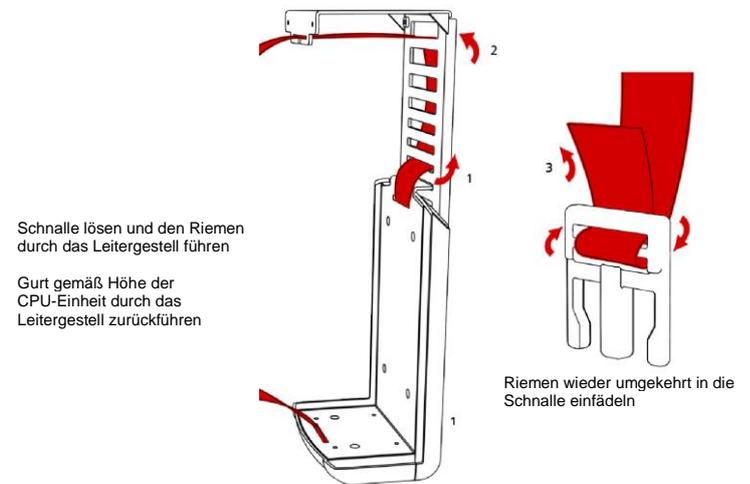
Schnalle lösen und den Riemen durch das Leitergestell führen
