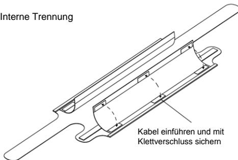
Kabel einführen und mit Klettverschluss sichern
